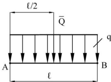
Рис. 13. Равномерно распределенная нагрузка
