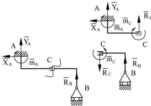
Рис. 11. Равновесие составной конструкции при соединении скользящей заделкой
