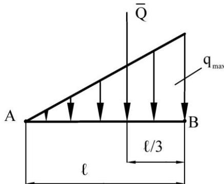
Рис. 14. Нагрузка, распределенная по линейному закону
