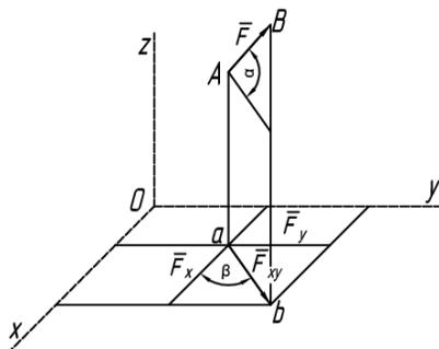
Рис. 34. Проекция вектора силы на ось и плоскость
