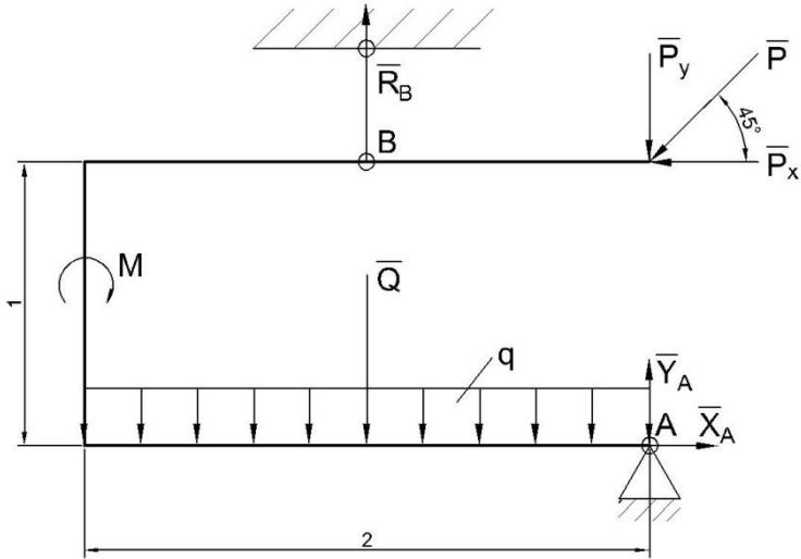
Рис. 17. Схема a) - равновесие бруса под действием активных сил и сил реакций
