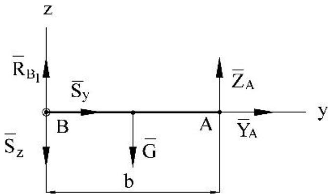
Рис.47. Определение момента системы сил относительно оси  $x$
