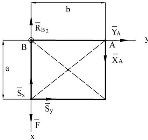
Рис. 49. Определение момента системы сил относительно оси z
