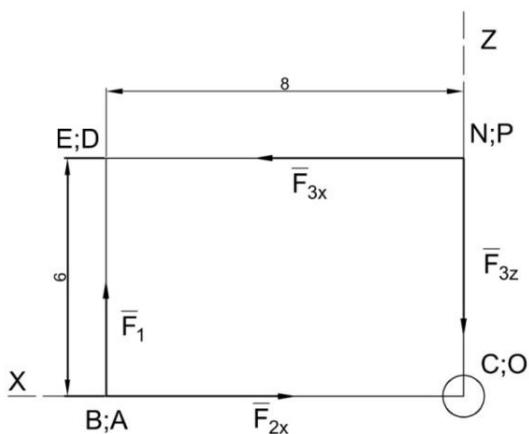
Рис. 42. Момент системы сил относительно оси y
