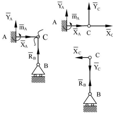
Рис. 10. Равновесие составной конструкции при шарнирном соединении
