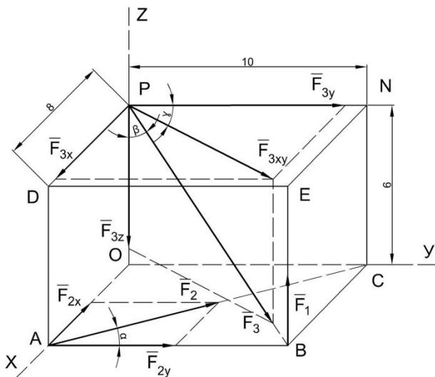
Рис. 39. Пространственная система сил
