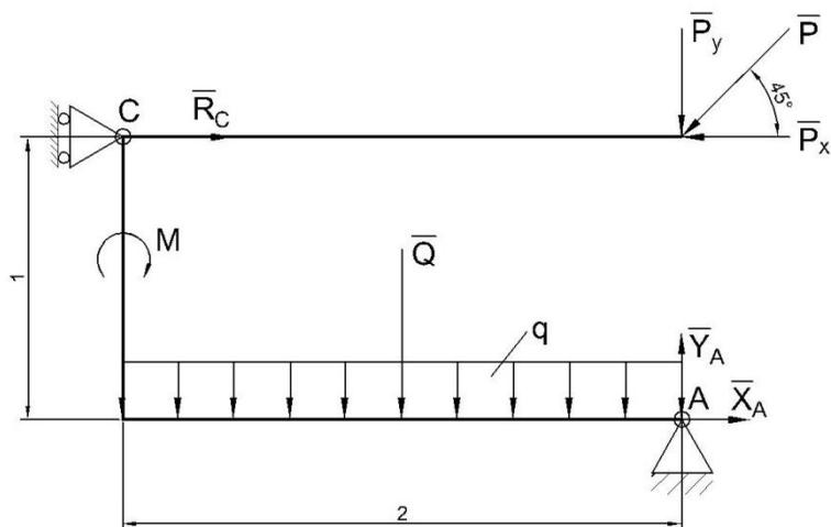
Рис. 18. Схема б) - равновесие бруса под действием активных сил и сил реакций
