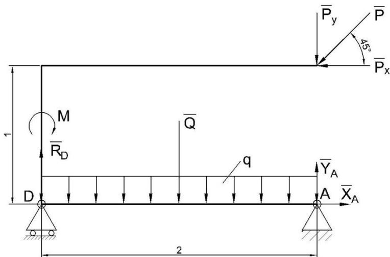
Рис. 19. Схема в) - равновесие бруса под действием активных сил и сил реакций
