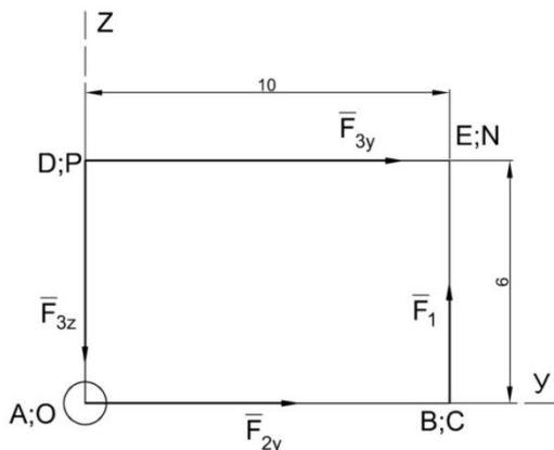
Рис. 41. Момент системы сил относительно оси x
