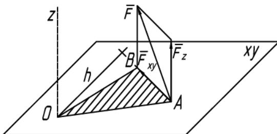
Рис. 36. Момент силы относительно оси z
