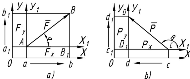
Рис. 7. Проекция силы на ось
