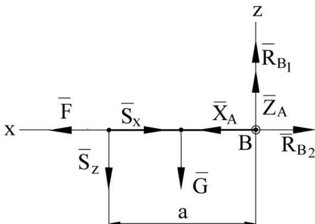
Рис. 48. Определение момента системы сил относительно оси  $y$
