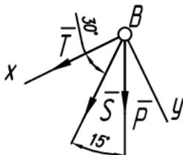
Рис. 16. Расчетная схема сходящейся системы сил
