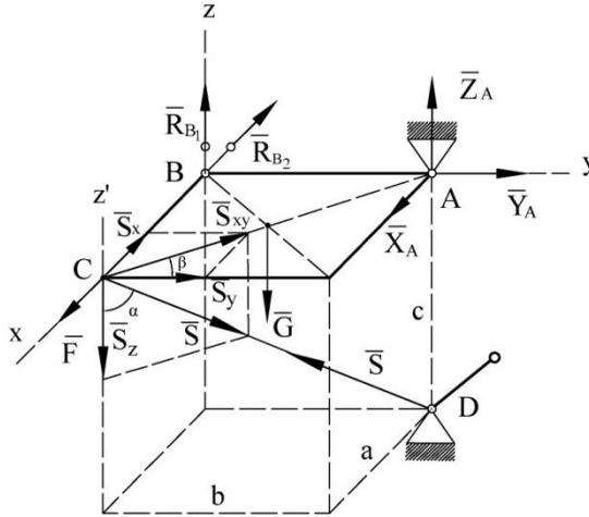
Рис.46. Равновесие полки
