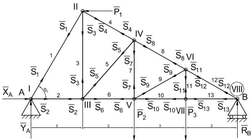
Рис. 20. Определение внешних (реакций в опорах) и внутренних (усилий в стержнях) реакций фермы.
