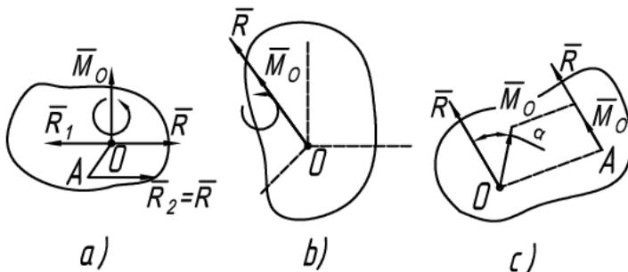
Рис. 38. Частные случаи приведения пространственной системы сил к заданному центру
