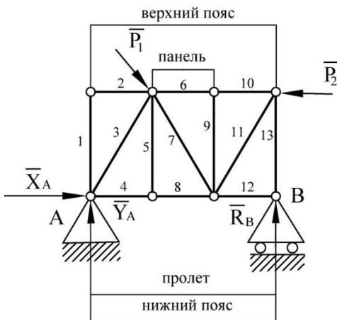
Рис. 12. Элементы плоской фермы с параллельными поясами.
