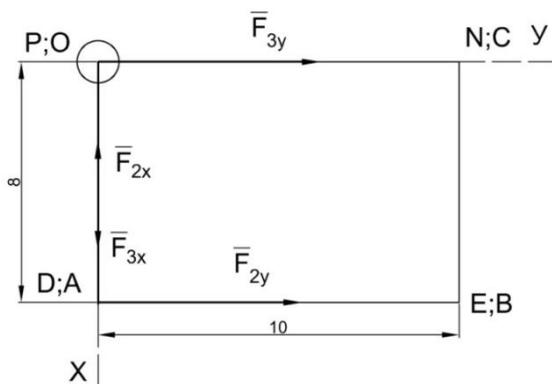
Рис. 43. Момент системы сил относительно оси z
