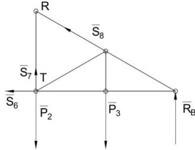
y:  $S_7 + S_8 \cdot \sin 30^\circ - P_2 - P_3 + R_B = 0$       Рис. 31. Сечение II - II
