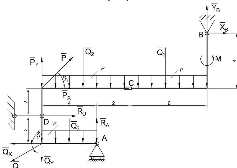
Рис. 32. Схема составной конструкции
